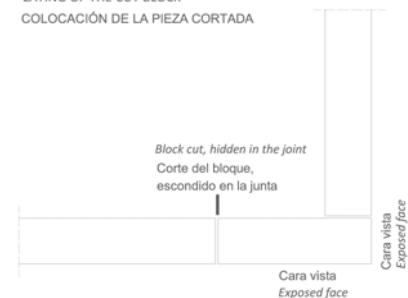
LAYING OF THE CUT BLOCK COLOCACIÓN DE LA PIEZA CORTADA
